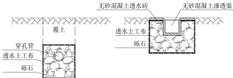
图 4-17 渗管/渠典型构造示意图
