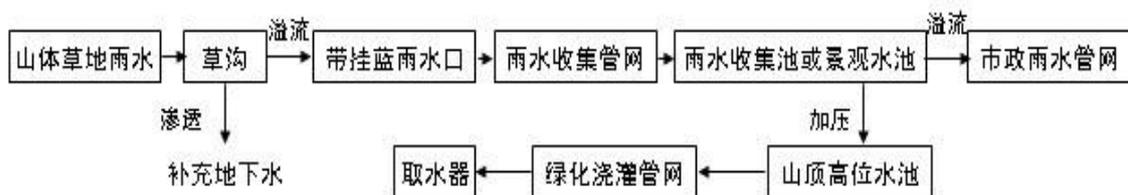
图 F4-3 光明新城公园低影响开发雨水系统流程图
