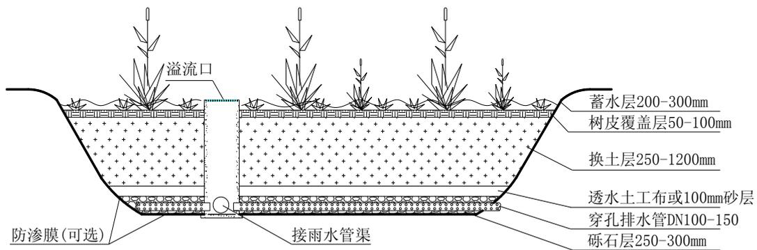
图 4-10 复杂型生物滞留设施典型构造示意图
