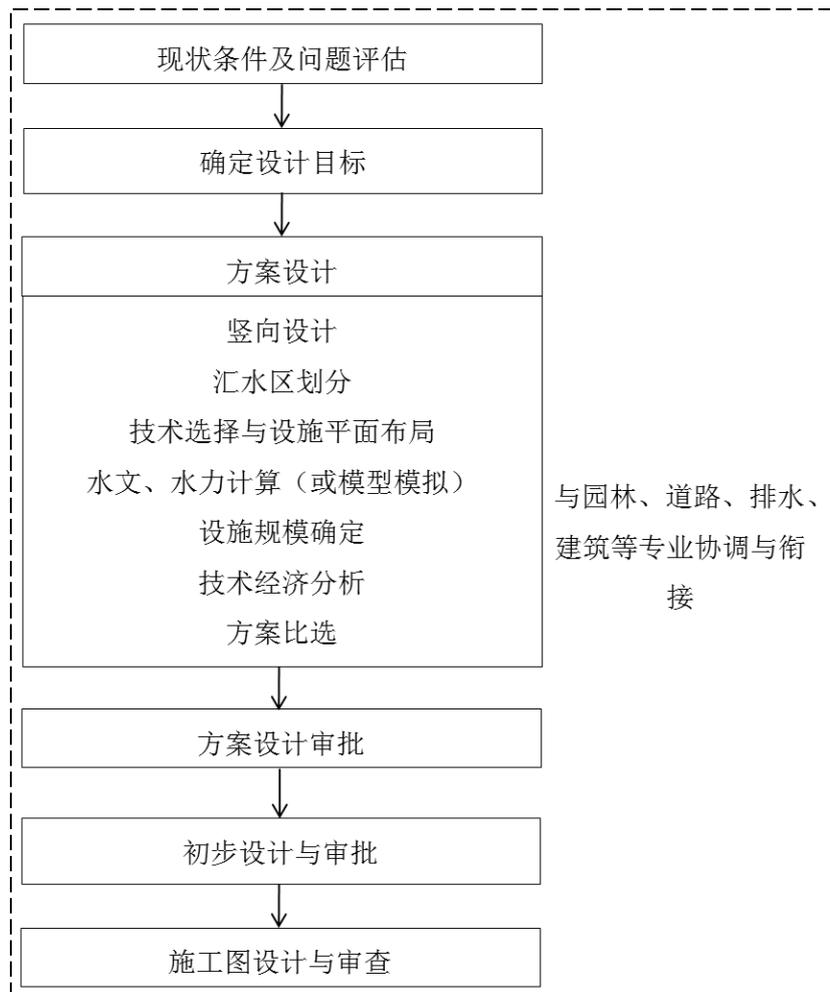
图 4-1 低影响开发雨水系统设计流程
