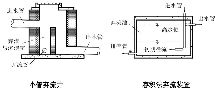
图 4-19 初期雨水弃流设施示意图
