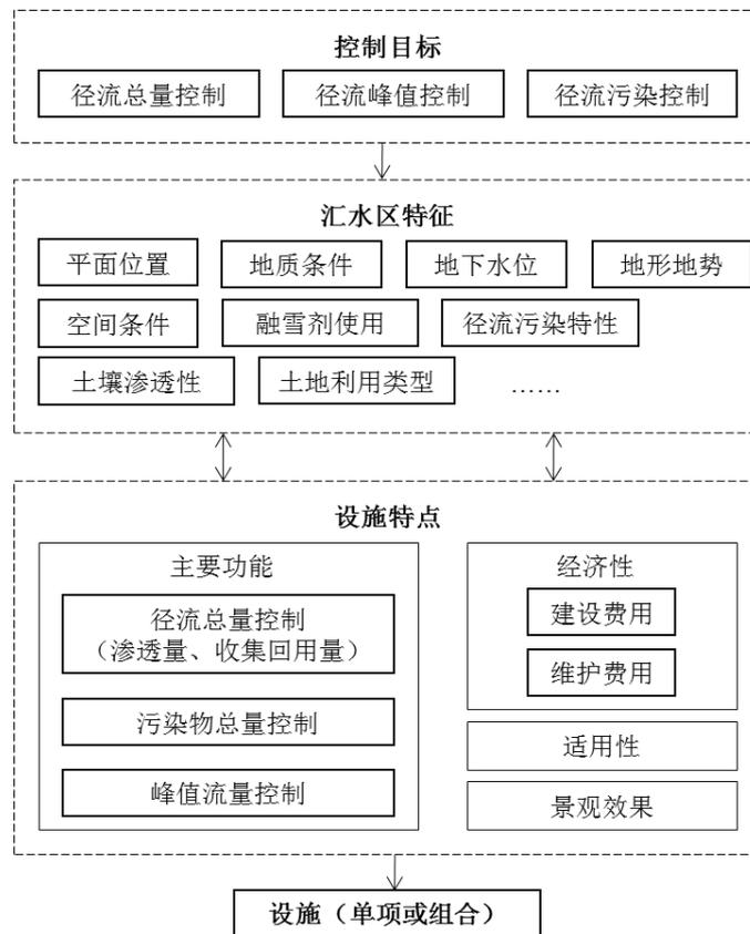
图 4-20 低影响开发设施选用流程图
