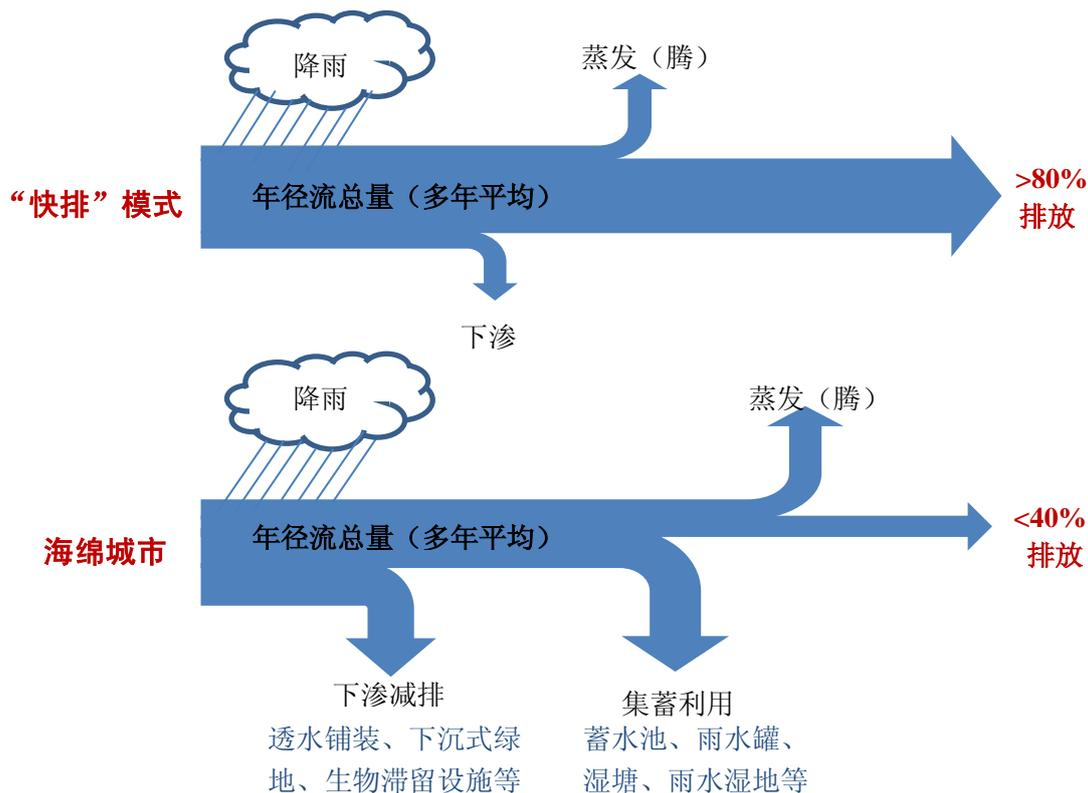
图 3-2 年径流总量控制率概念示意图
