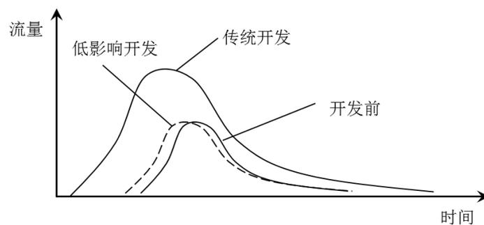
图 2-1 低影响开发水文原理示意图
