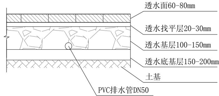
图 4-6 透水砖铺装典型结构示意图
