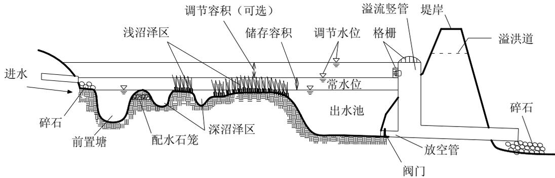
图 4-14 雨水湿地典型构造示意图
