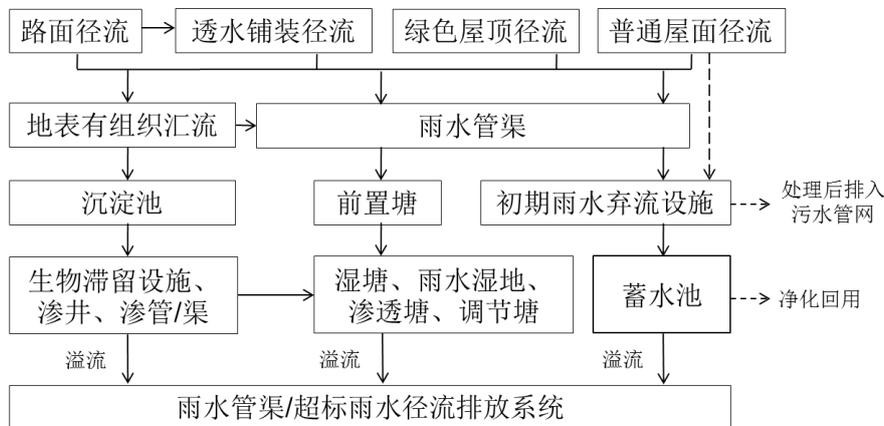
图 4-2 建筑与小区低影响开发雨水系统典型流程示例
