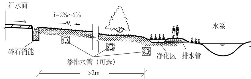
图 4-18 植被缓冲带典型构造示意图
