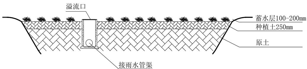
图 4-8 狭义的下沉式绿地典型构造示意图
