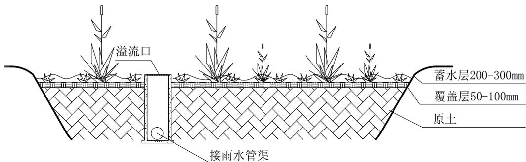
图 4-9 简易型生物滞留设施典型构造示意图
