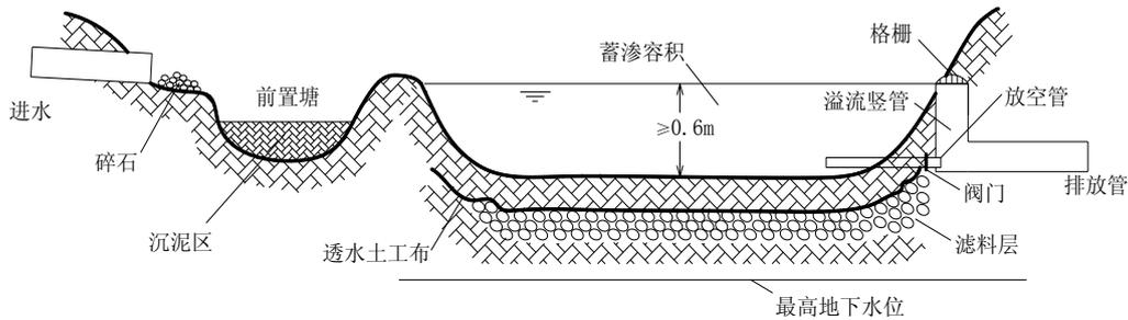
图 4-11 渗透塘典型构造示意图
