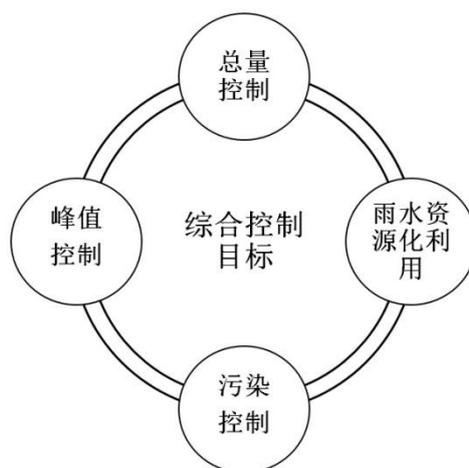
图 3-1 低影响开发控制目标示意图
