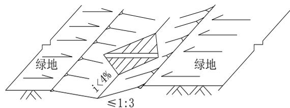
图 4-16 转输型三角形断面植草沟典型构造示意图
