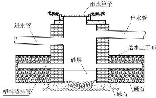
图 4-12 辐射渗井构造示意图
