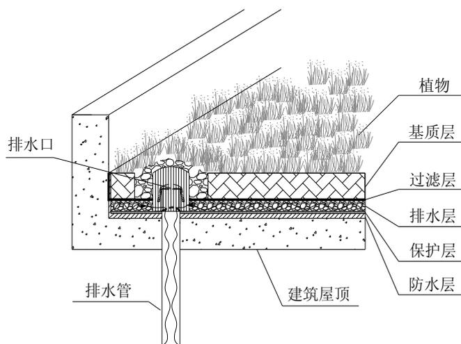
图 4-7 绿色屋顶典型构造示意图
