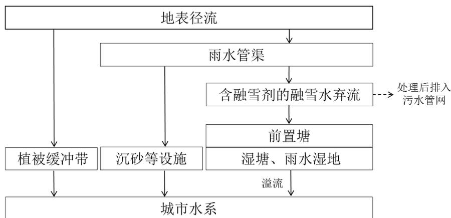
图4-5 城市水系低影响开发雨水系统典型流程示例
